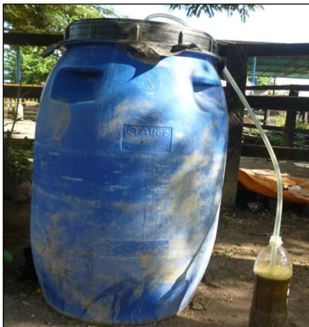
*Nota.* Sellado del cilindro y conexión mediante una manguera y botella. Fuente: Amestyj (2018).
