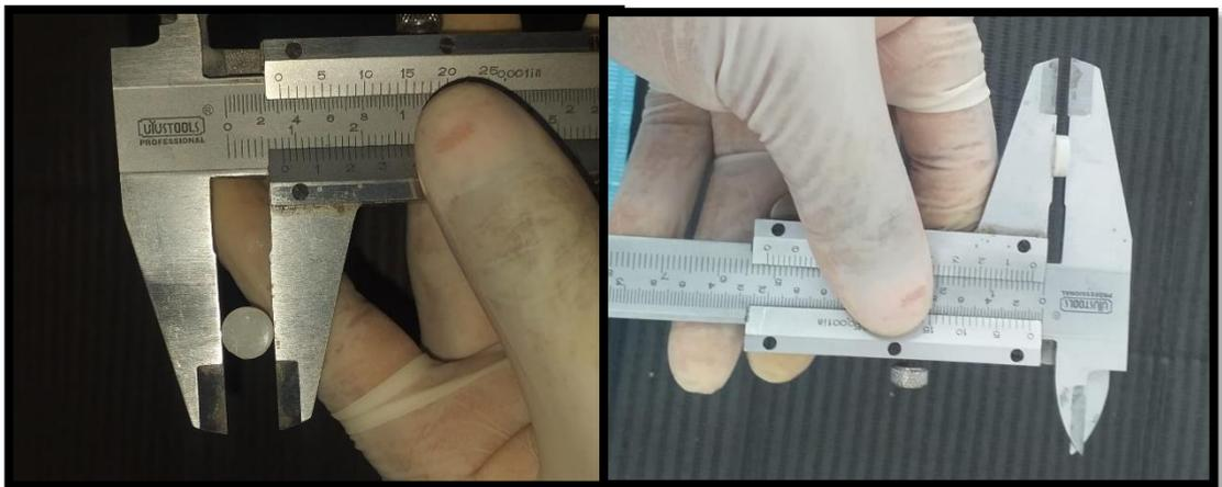
**Calibración de las muestras de resina con VERNIER.**
